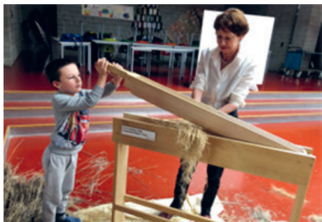
Fig. 19 – Un élève utilise la broyeuse à lin pour « amollir » les fibres de lin..
