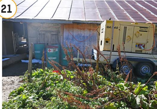
Un **générateur diesel** est un moteur qui fonctionne au diesel et est utilisé dans les situations d'urgence pour produire du courant. Comme pour tous les moteurs diesel, cela génère des gaz d'échappement.
